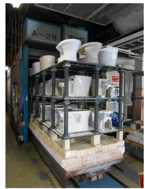
TOTO小倉第一工場での各種工程 TOTO(株) 提供 (左: 1971年築炉のトンネル窯から出てきた製品/中: 機械による施釉工程/右: 人による成形された製品のチェック)
