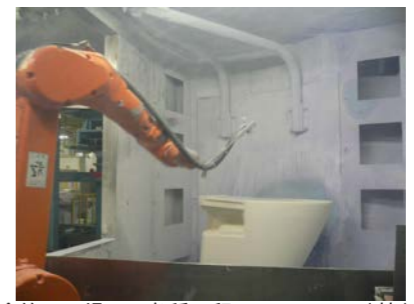
TOTO小倉第一工場での各種工程 TOTO(株) 提供 (左: 1971年築炉のトンネル窯から出てきた製品/中: 機械による施釉工程/右: 人による成形された製品のチェック)
