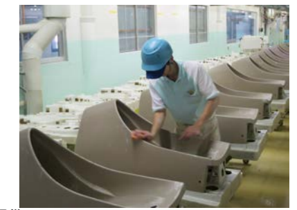
TOTO小倉第一工場での各種工程 TOTO(株) 提供 (左: 1971年築炉のトンネル窯から出てきた製品/中: 機械による施釉工程/右: 人による成形された製品のチェック)
